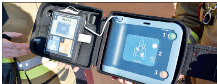
Urządzenie jest bardzo proste w obsłudze. Wystarczy nacisnąć przycisk start i samo zakomunikuje co i jak należy robić, by ratować osobę u której doszło do nagłego zatrzymania krążenia.
